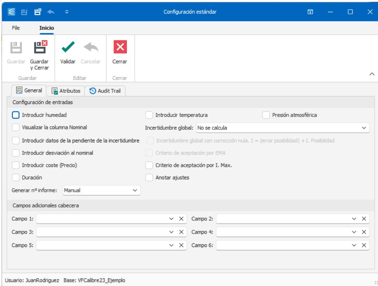
En **Introducir temperatura**, **Introducir humedad** **presión atmosférica** indicaremos si introduciremos estos valores en el control. Los valores por defecto se tomarán de lo indicado en la configuración de la aplicación.
